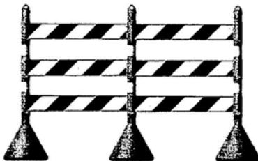
Los señalizadores deben contar con por lo menos dos cintas retroreflectivas blancas de 3 pulgadas de ancho, de especificación mínima de grado ingeniería y deben contar con un
